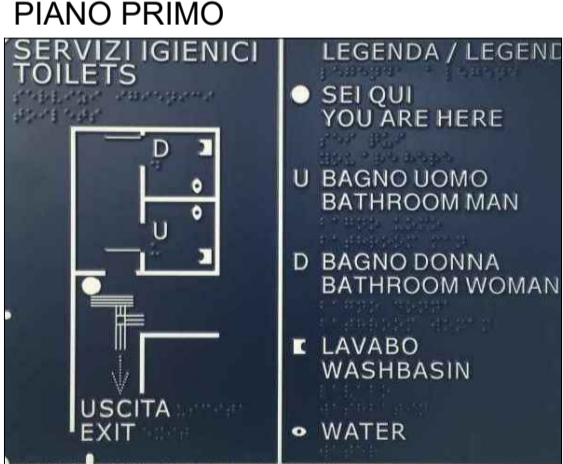
Tipo di mappa tattile del bagno: obiettivo è quella di dare al disabile visivo l'informazione sulla disposizione dei sanitari e degli altri accessori per migliorare l'orientamento all'interno del bagno.
